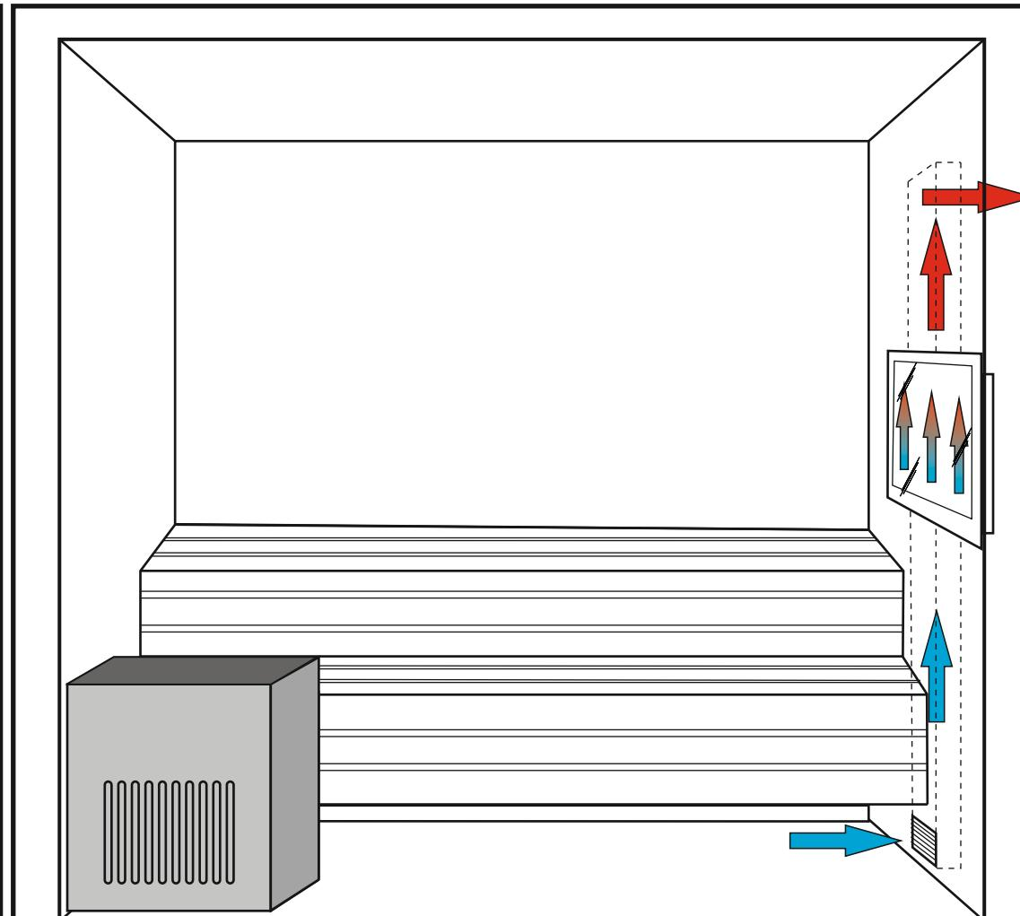
Вентиляционный канал должен подавать холодный воздух в нижнюю часть монтажного короба телевизора, по центру, а нагретый воздух отводить из верхней части. Сечение вентиляционного канала должно быть эквивалентно диаметру трубы не менее 100 мм.
